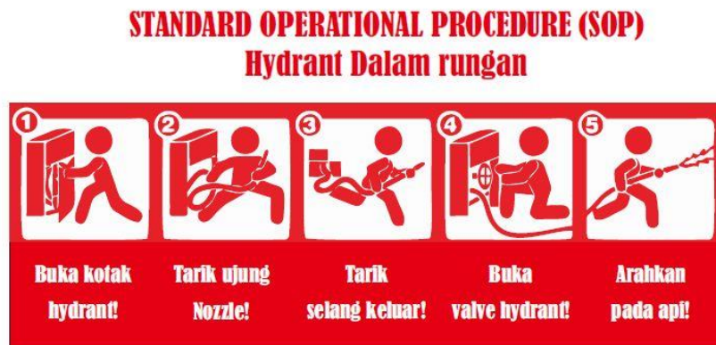
Gambar 65. SOP penggunaan hydrant
